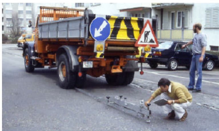
Figura 3.11: Misura di deflessione con trave Benkelman.
