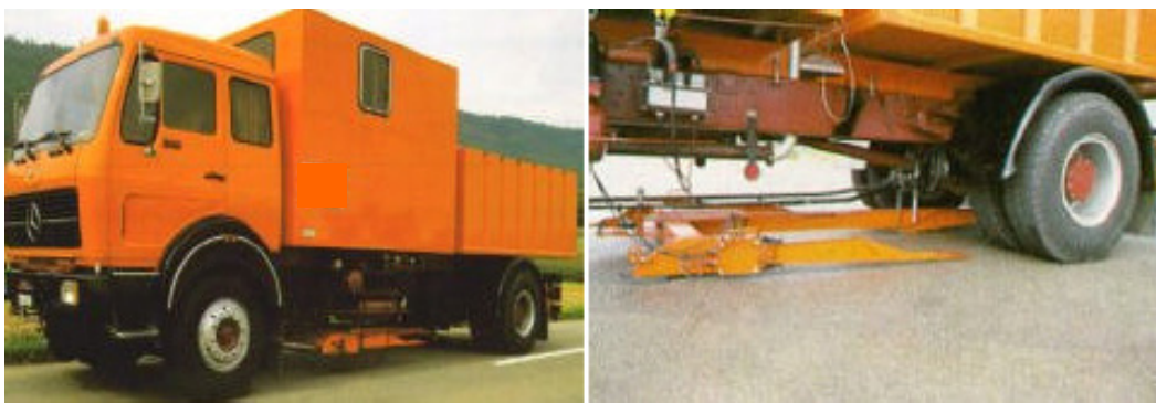
Figura 3.12: Deflectographe Lacroix, a sinistra con dispositivo di misura alzato, a destra con dispositivo di misura abbassato.
