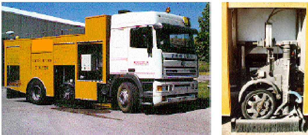
Fig. 3.10.: Apparecchio SCRIM (Sideway Coefficient Road Investigating Machine) per la misura dell'aderenza; a sinistra vista generale del veicolo con serbatoio d'acqua, a destra dettaglio del dispositivo di misura.
